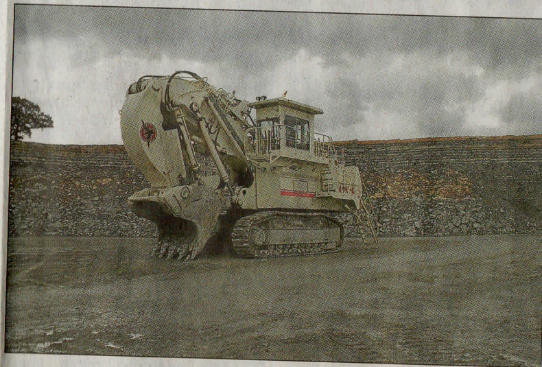
Mit diesem riesigen Bagger werden die Kalksteine aus der Steinbruchwand gebrochen und zum Abtransport auf die Lkw verladen.
